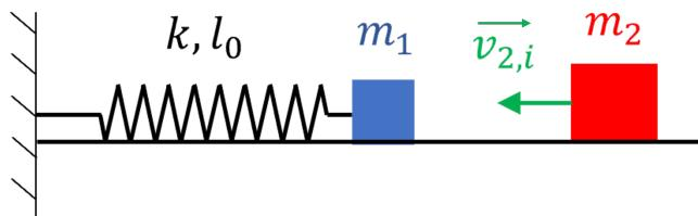
On considère une masse  $m_1$  qui peut glisser sans frottements sur le sol horizontal. Elle est attachée à un ressort de raideur  $k$  et de longueur au repos  $l_0$ , lui-même fixé à une paroi immobile. On lance une masse  $m_2$  contre  $m_1$  avec une vitesse  $\vec{v}_{2,i}$ . Les deux masses restent collées après le choc. On notera  $x(t)$  la position du système composé des deux masses après le choc.
